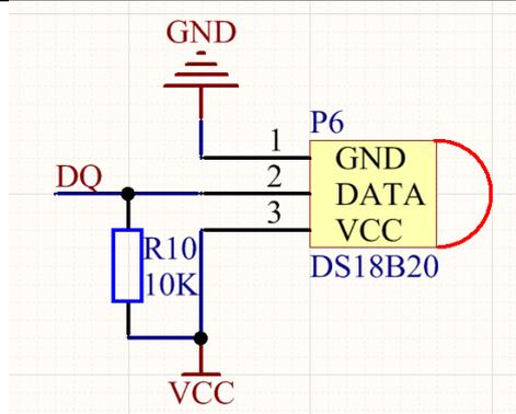
Fig. 3 DS18B20 circuit diagram
